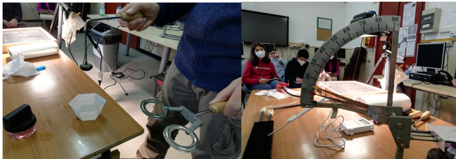
Anello usato per l'esperimento della dilatazione di un corpo
