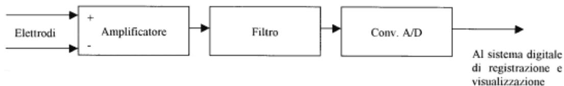
Il segnale elettrico, proveniente dai due elettrodi applicati al paziente, si presenta all'amplificatore in modo differenziale ed ha valore compreso fra  $-0.8\text{ mV}$  e  $+0.8\text{ mV}$  con componenti armoniche significative in banda  $0.1 \div 40\text{ Hz}$ . Detto segnale è disturbato dalla tensione di rete a  $50\text{ Hz}$  presente nell'ambiente.
